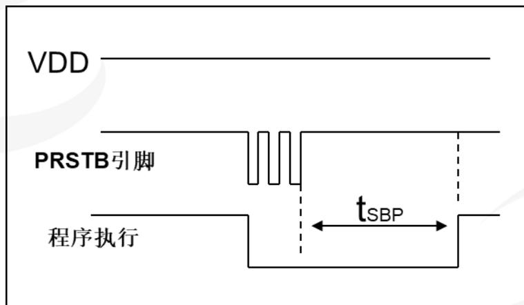
图 6：外部引脚复位的相关时序
