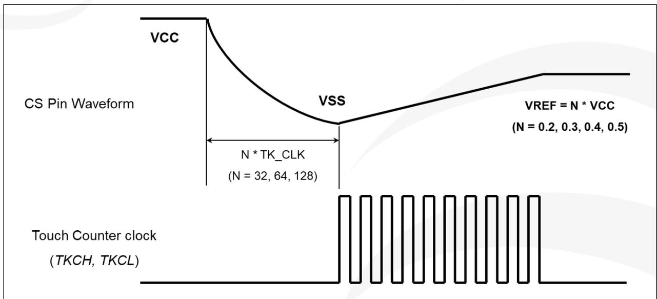
图 19: 触摸转换进度时序图
