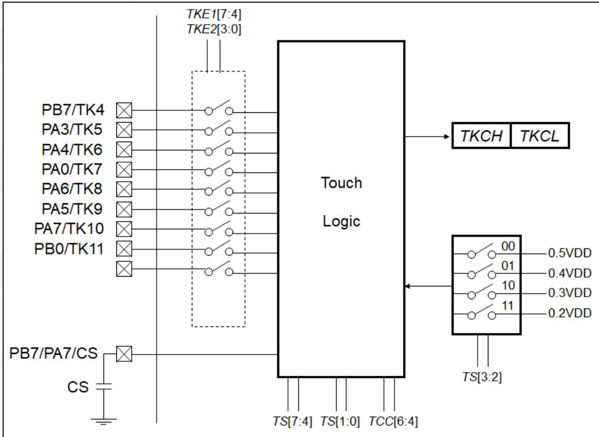
图 18: 触摸检测电路功能框图
