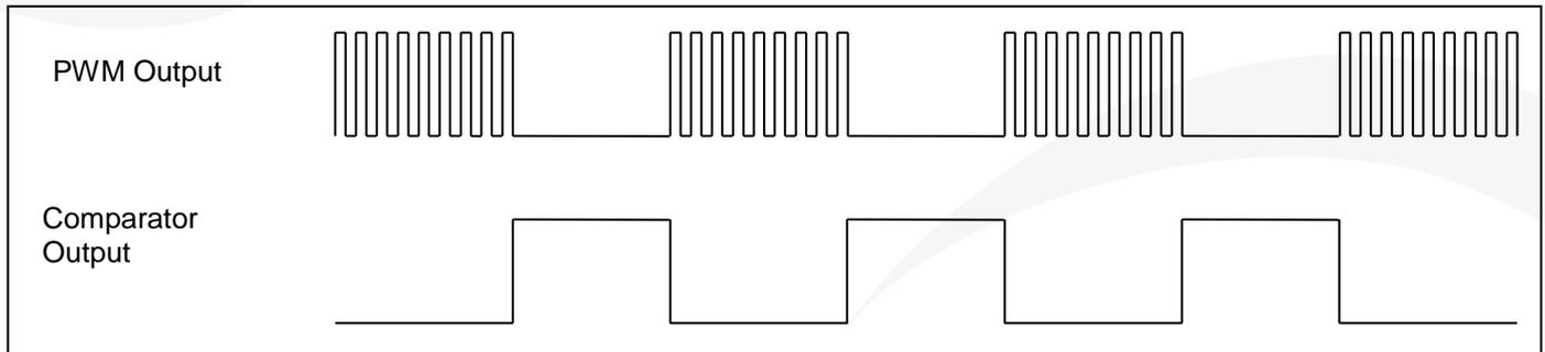
图 12: 比较器控制 PWM 输出
