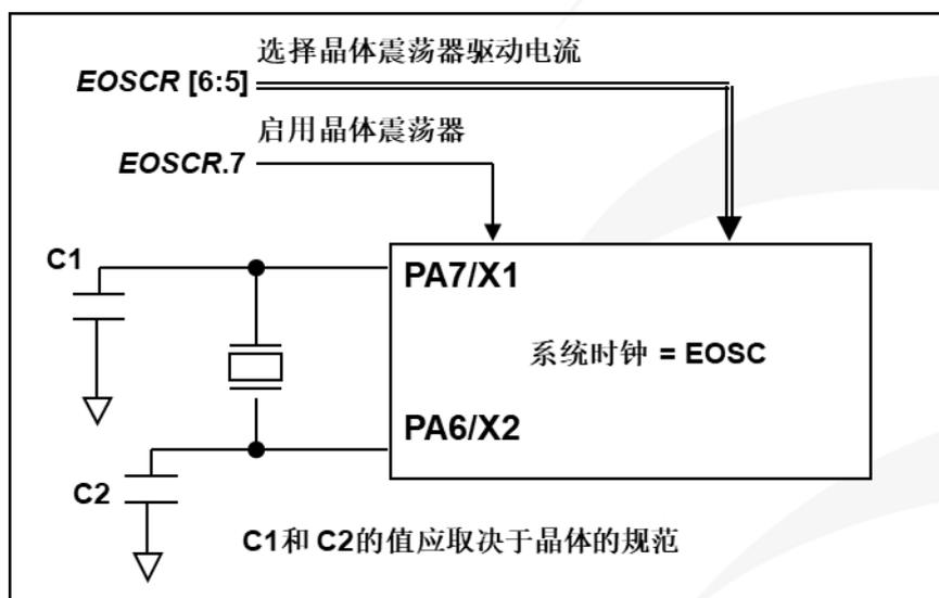
图 1: 外部晶体振荡器的硬件连接
